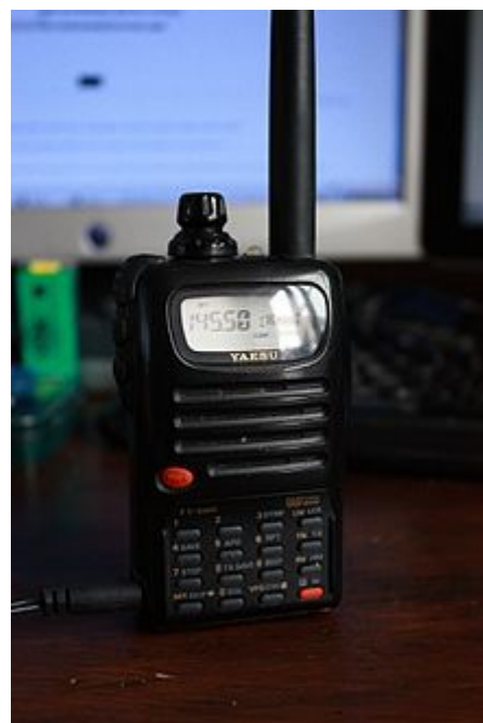
Un émetteur récepteur radioamateur de quelques watts alimentant une simple antenne fouet pour des liaisons locales sur 145,500 MHz.
