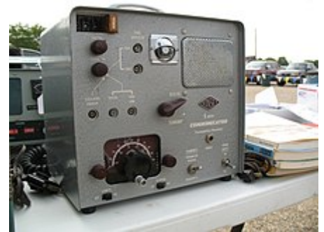
émetteur-récepteur «Gooney Box» en AM. Avec un œil magique pour indiquer l'accord, et était populaire dans les années 1950 et 60. (La version de 6 mètres sur cette image a également été vendue).
